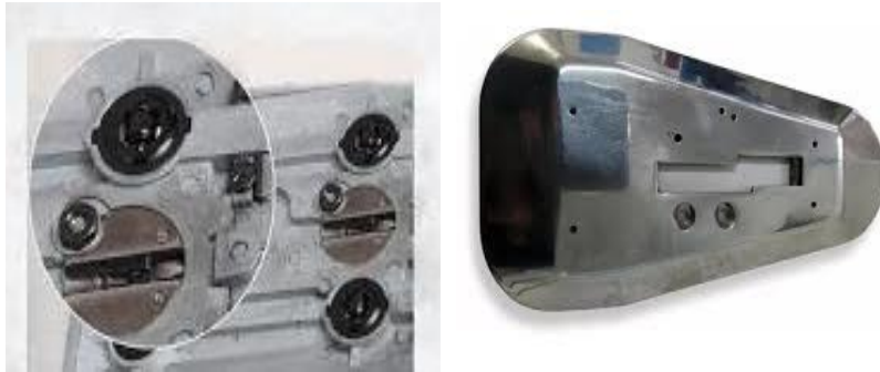
Figura 56 Rodillos de la base de la cortadora de tela
